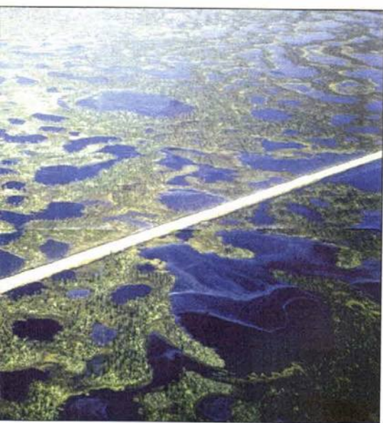
Термокарстовые озера в районе автомобильной дороги Сургут – Новосибирск.
